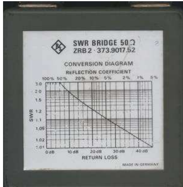
Az SWR mérőhíd és az átszámító táblázat
